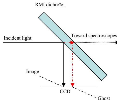
Figure 5 : light rays on the RMI dichroïc
