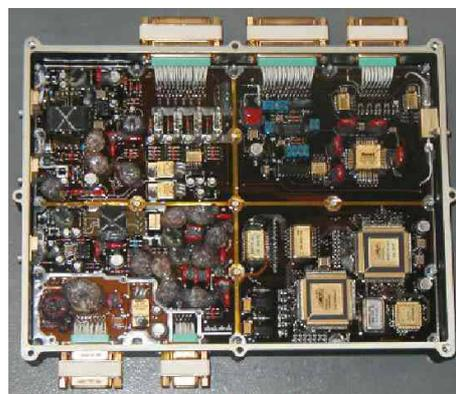
Figure 7. Atermes PRECard Flight-Model.
