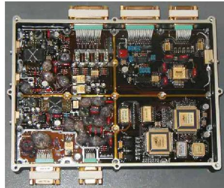
Figure 5. Atermes PRECard Flight-Model
