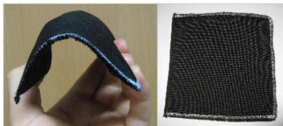
**Figure 16-5: Textile Antenna (L-Band version)**
